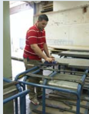
Jedes Bauteil wird fein säuberlich per Hand entgratet.
